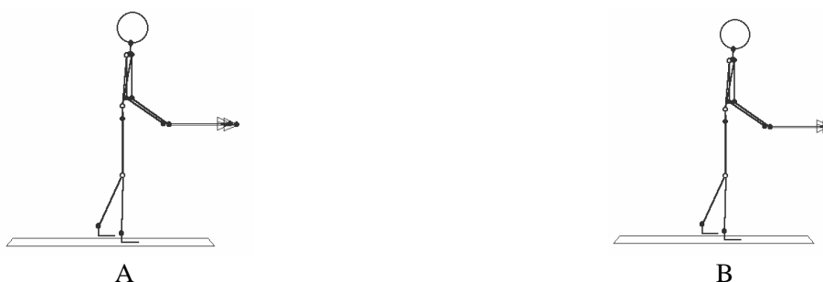
FIGURA 4: Postura assumida durante a alimentação na furadeira (A) e lixadeira de cinta (B).
