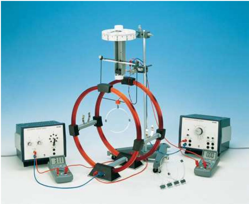
Figura 15.2: Esquema da balança de torção para medida do momento magnético de um anel com N espiras
